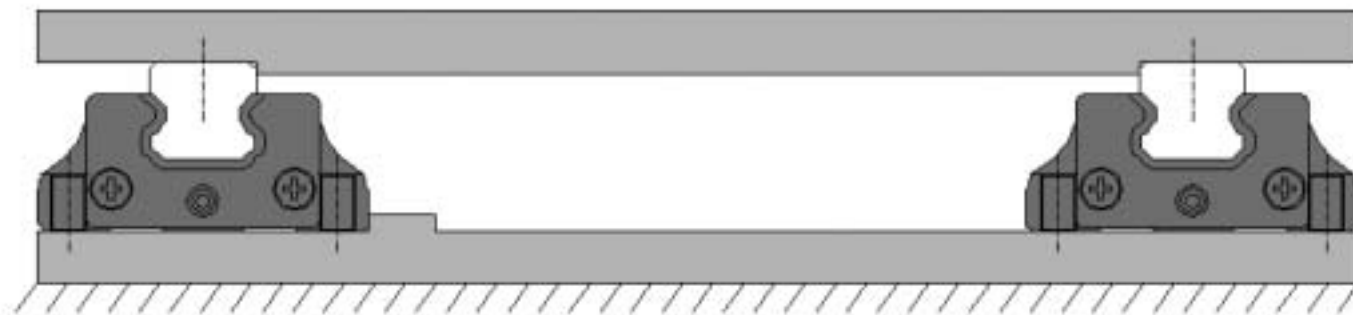
(B) Su piano orizzontale con pattini fissati (B) Horizontal plane with fixed blocks
